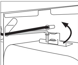
Ende des Auslaufrohrs um 90° gegen den Uhrzeigersinn drehen.
