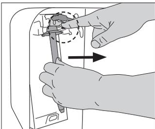
Pumpensperre mit dem Finger gedrückt halten und Pumpe nach vorne herausziehen. Dazu gleichzeitig die Spendereinheit oben nach hinten schwenken, um die Pumpe nach vorne herausnehmen zu können.
