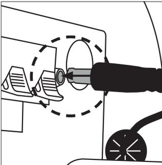
Der Kleinspannungsstecker vom Netzteil wird durch ein Loch in der Rückseite oder im Boden geführt. Die Batterien werden beim Einstecken des Netzteils automatisch abgeschaltet. Den Kleinspannungsstecker bitte in die vorhergesehene Buchse im Innenraum einstecken.
